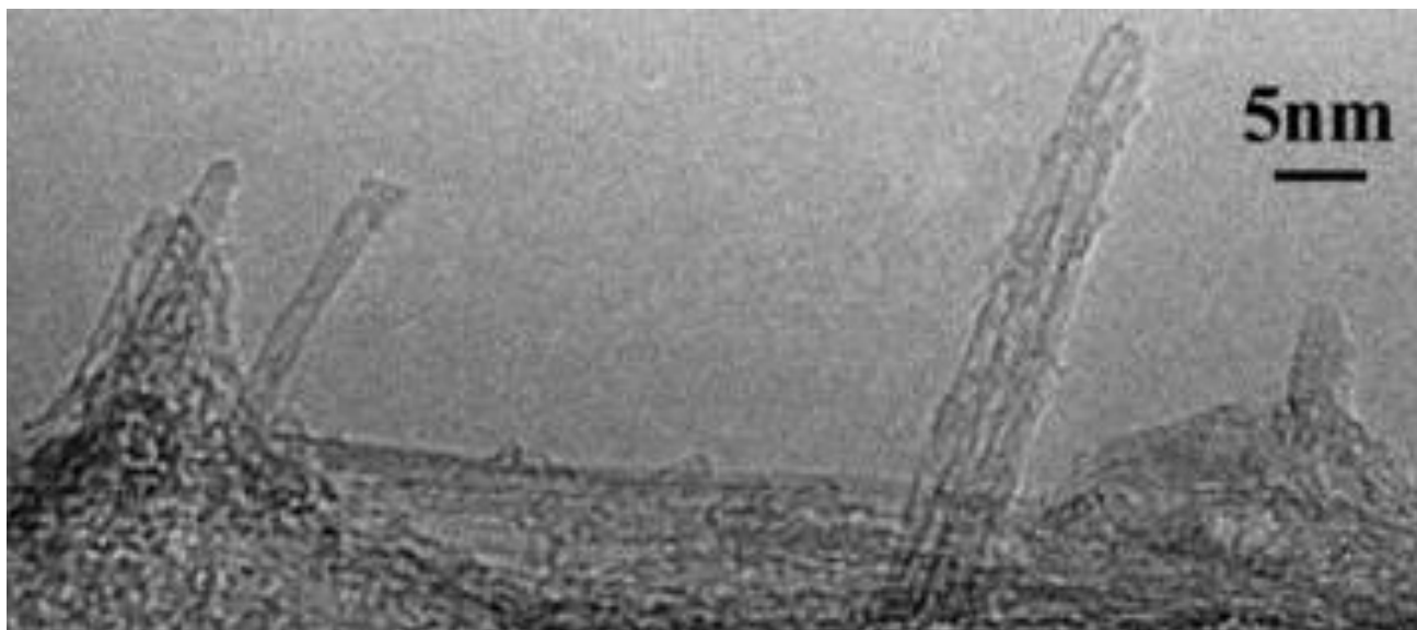
Рис. 2.5 Изображение ОСНТ заполненных наночастицами Fe полученными из раствора \text{Fe}(\text{NO}_3)_2 при комнатной температуре с последующим отжигом при 300°C, получено с помощью ПЭМ высокого разрешения
