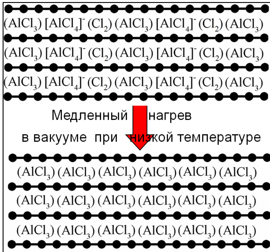
Рисунок 82. Гипотетическая возможность получения трехмерной гетеро-структуры графен - диэлектрик - графен - диэлектрик - графен.
