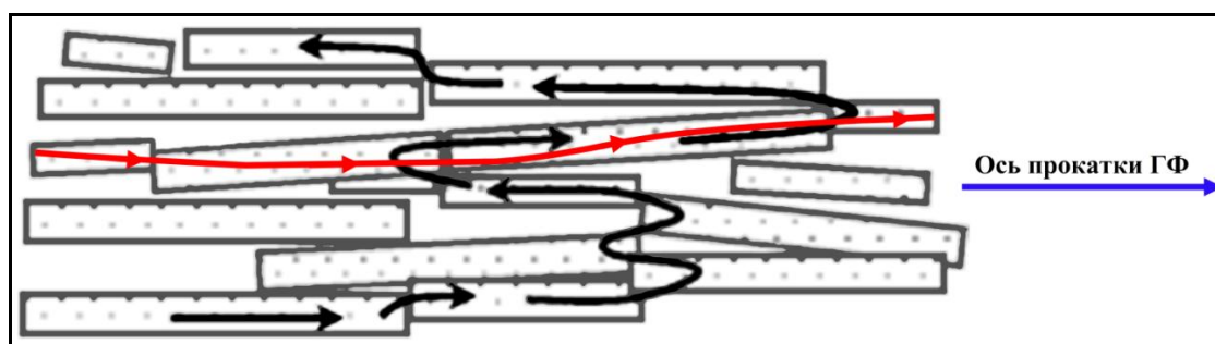
Рисунок 151. Схематическое изображение одной из возможных траекторий движения носителя заряда в направлении плоскости оси прокатки и в направлении, перпендикулярном поверхности графитовой фольги.
