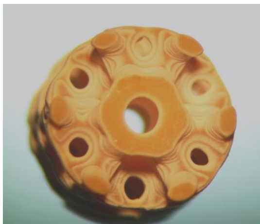
Рис. 4.71. Фотография композита (полимер/порошок) цилиндрической формы со структурой Кельвина вдоль направления [111]. Диаметр пор 750 мкм.
