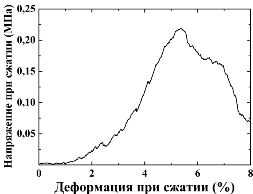
Рис. 4.66. Зависимость напряжения при сжатии от деформации для керамического материала на основе \text{Ca}_{2,3}\text{Na}_{1,4}(\text{PO}_4)_2 полученного методом репликации ППУ.
