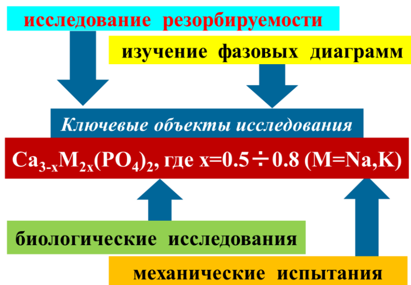
Рис. 4.52. Схема стратегии выбора составов смешанных фосфатов кальция и щелочных металлов для получения макропористой керамики
