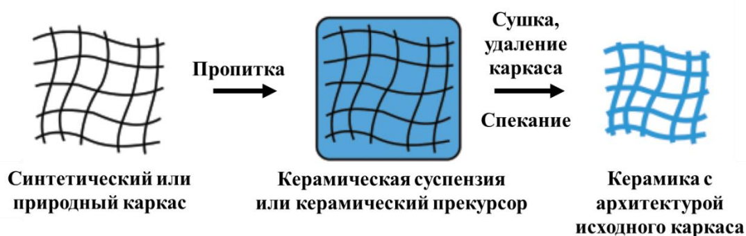
Рис. 2.12. Схема получения керамики методом реплики [49]
