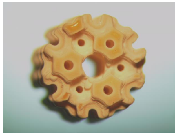
Рис. 4.72. Фотография композита (полимер/порошок) цилиндрической формы со структурой Кельвина вдоль направления [111]. Диаметр пор 500 мкм.
