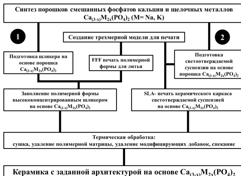
Рис. 3.1. Блок-схема технологического процесса получения остеокондуктивной керамики с заданной архитектурой на основе смешанных фосфатов кальция и щелочных металлов.
