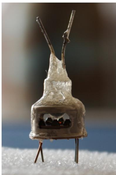
*Рис. 3.5 Внешний вид прототипа газового сенсора*
