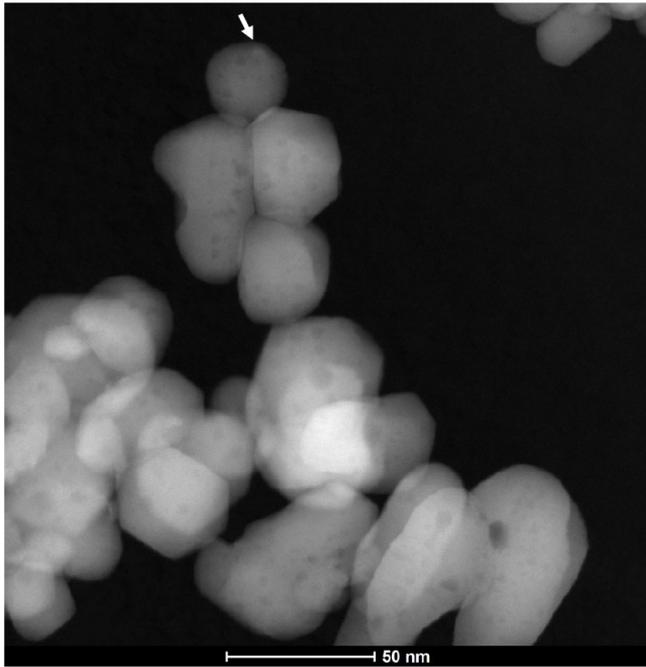
Рис. 4.18 Изображение нанокompозита ZnO/QD\_CdSe(MPA), полученное методом HAADF-STEM. КТ CdSe показана стрелкой (масштаб 50 нм).
