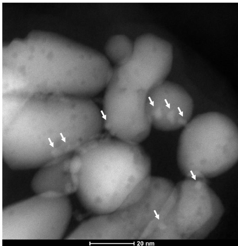
Рис. 4.14 Изображение нанокompозита ZnO/QD\_CdSe(ole), полученное методом HAADF-STEM. КТ CdSe показаны стрелками. Между зёрнами ZnO можно видеть агломерированные квантовые точки.
