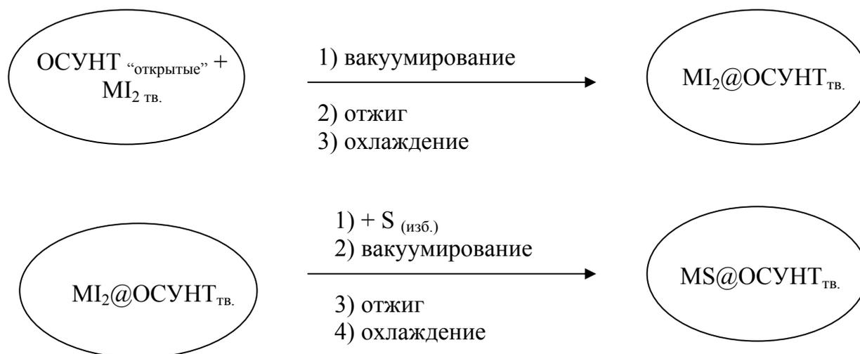
Рис.9 Схема получения MS@ОСНТ.
