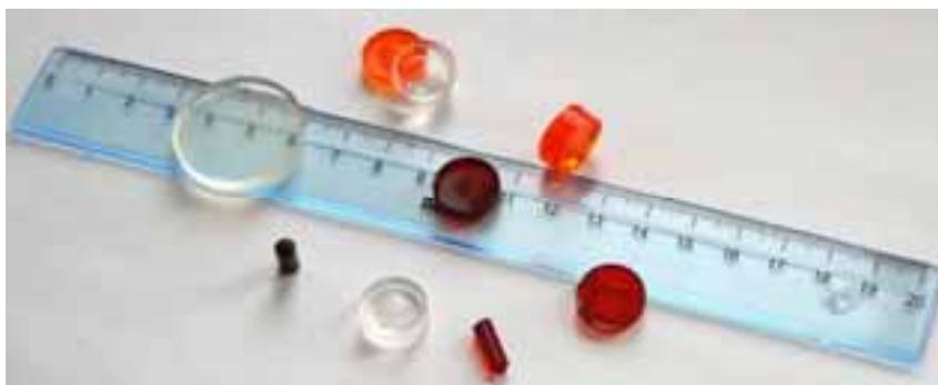
**Рис. 1. Образцы нанокompозитов.**
