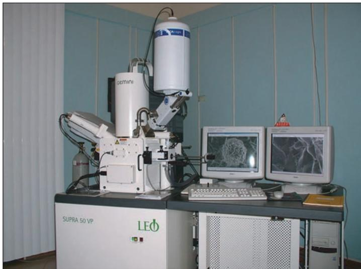
Сканирующий электронный микроскоп высокого разрешения Supra 50VP
