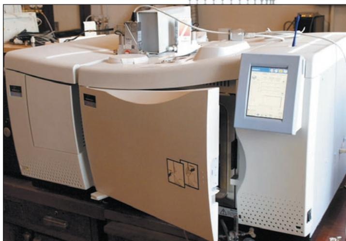
Газовый хроматограф высокого разрешения с масс-спектрометрическим детектором CLARUS 600
