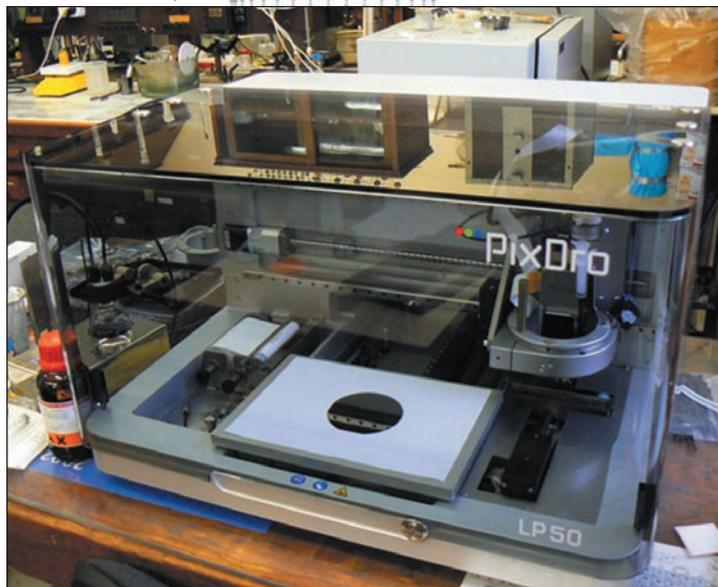
Система формирования планарных структур методом трехмерной печати LP 50
