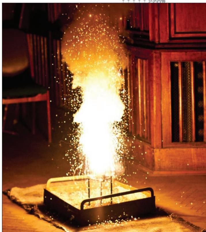
Просто алюмотермия (экспресс - выплавка слитка железа).
