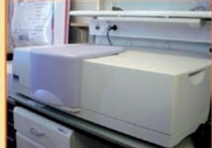
измерения спектров диффузного отражения в среднем ИК-диапазоне в широком интервале температур (25–500°С) и давлений (от 10<sup>-3</sup> торр до 34 атм) в контролируемой газовой среде
