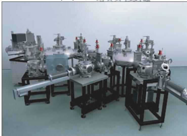
НаноФаб – конвейер для нанoeлектроники. На рисунке изображены два многомодульных кластера (НТ-МДТ 2007)
