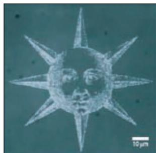
Оптическая микрофотография «солнца», состоящего из примерно 20000 индивидуальных 60 нм частиц золота. (источник: Nature Nanotechnology)
