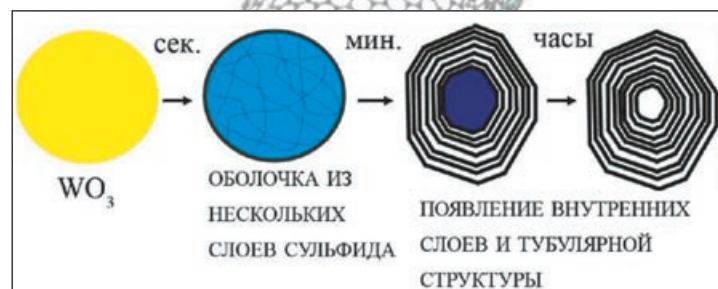
Процесс трансформации триоксида молибдена или вольфрама в нанотрубчатые и фуллерено-подобные структуры при взаимодействии с сероводородом.
