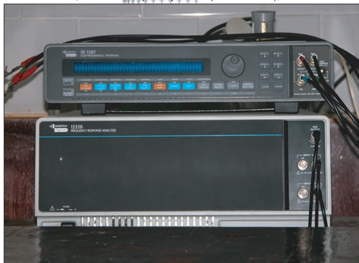
Электрохимическая система потенциостат Solartron 1287/ анализатор частот Solartron 1255B (Solartron)
