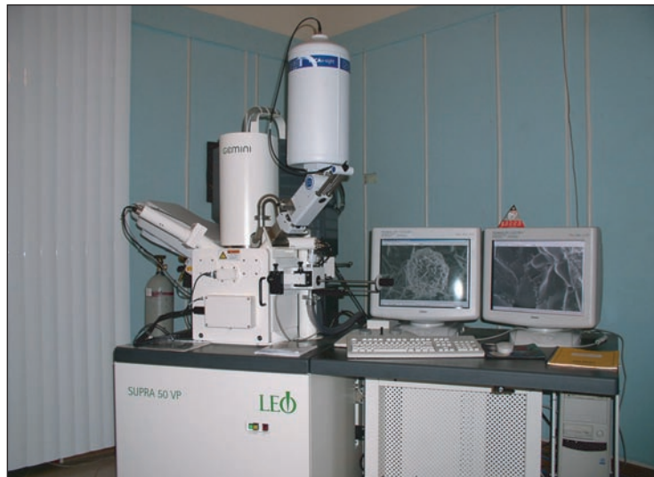
Сканирующий электронный микроскоп высокого разрешения Supra 50VP (LEO) с системой микроанализа INCA Energy+ (Oxford) различных вариантов исследования (магнито-силовая микроскопия и др.)
