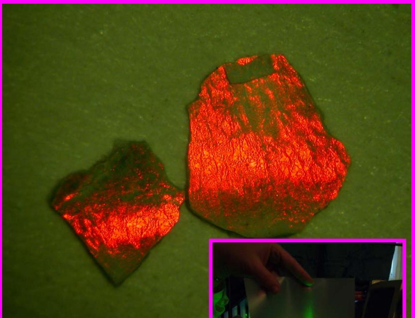
Необычная игра света, характерная для опалов, имеет дифракционную природу. Однако дифракцию света на образцах опалов удается наблюдать лишь в редких случаях на наиболее совершенных образцах. На рисунке справа представлена фотография эксперимента по визуализации дифракционной картины лазерного излучения, проведенного совместно сотрудниками каф. неорг. химии Химфака и каф. физики полимеров Физфака МГУ.
