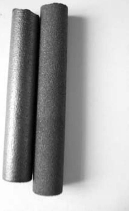
Альтернативная технология – тонкостенную керамическую трубку («папиросная бумага»), полученную шликерным литьем и магнитно-импульсным прессованием с последующей термообработкой (слева) подвергают поверхностному плавлению и кристаллизации пучком лазера для получения химически и физически совместимого с материалом трубы поверхностного слоя – газоплотной пленки (верхняя фотография).
