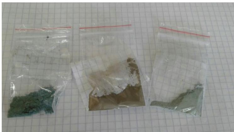
Рис. 19. Слева направо  $Zn_{0,1}Ni_{0,9}Al_2O_4$ ,  $Zn_{0,7}Ni_{0,3}Al_2O_4$ ,  $Zn_{0,5}Ni_{0,5}Al_2O_4$
