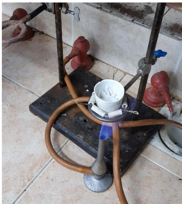
*Рисунок 5. Прокаливание на газовой горелке.*
