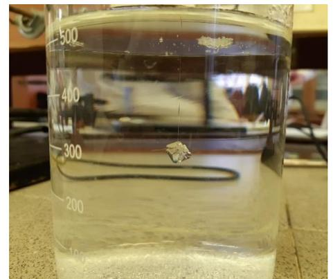
*Рисунки 3, 3, 5. Процесс роста кристалла алюмоаммонийных квасцов.*
