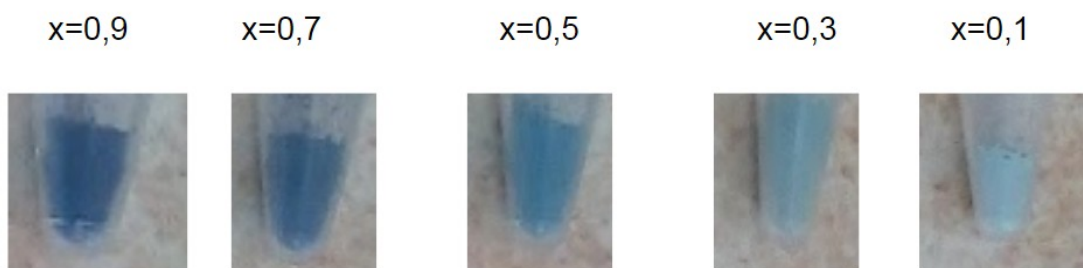
Рис.8 Зависимость цвета от содержания кобальта для Zn_{1-x}Co_xAl_2O_4
