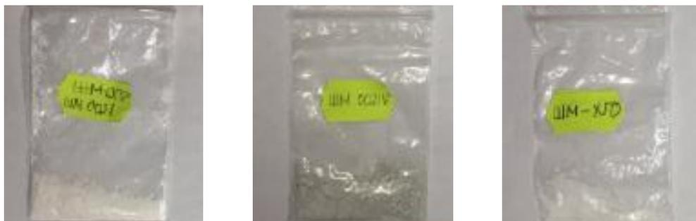
Рис. 2.  $ZnAl_2O_4$ : с применением методов химической (1) и механической гомогенизации с обжигом при  $900^\circ C$  (2) и  $1200^\circ C$  (3)
