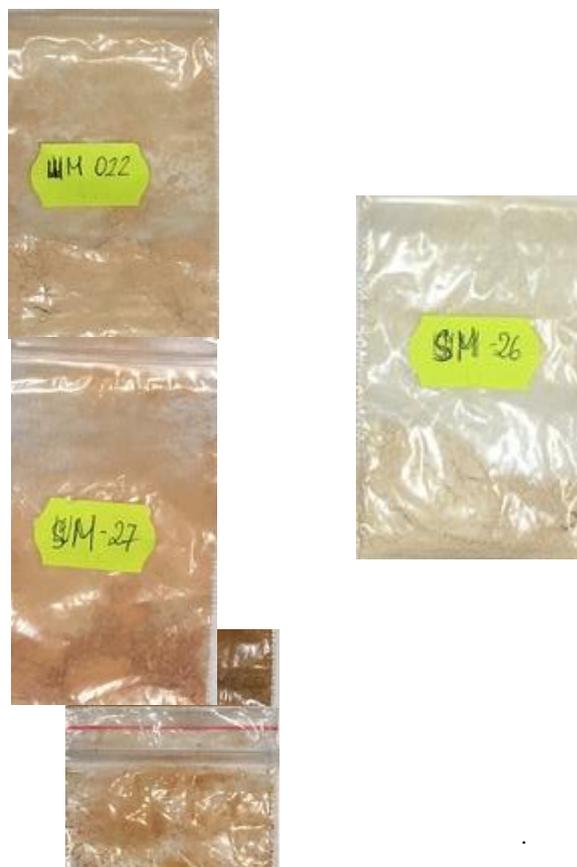
Рис.3.  $\text{ZnAl}_{1,8}\text{Fe}_{0,2}\text{O}_4$ ,  $\text{Fe}_{0,2}\text{Zn}_{0,8}\text{Al}_2\text{O}_4$  и  $\text{Fe}_{0,02}\text{Zn}_{0,98}\text{Al}_2\text{O}_4$ , обожженные при 900 °C (сверху) и 1200 °C (снизу)
