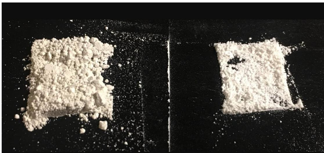
Рис. 7. Образцы состава  $Fe_{0,02}Zn_{0,98}Al_2O_4$ ; в качестве источника железа использованы  $(NH_4)_2Fe(SO_4)_2 \cdot 6H_2O$  (1) и  $Fe_2(SO_4)_3 \cdot 9H_2O/Fe$ (карб) (2)
