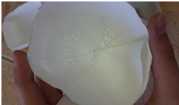
Рис.7 Фильтр после сушки в сушильном шкафу
