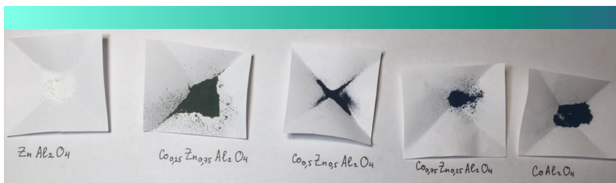
Рис.10 Градиент цвета шпинелей, обожженных при 900°C
