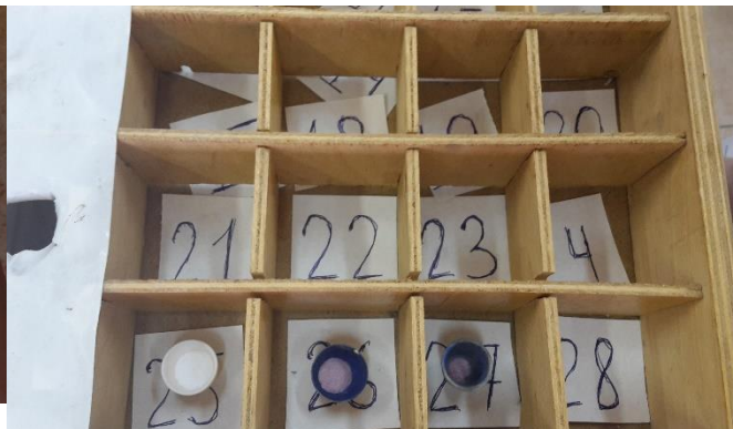
Рис.8 Тигли на обжиг при 1200 °С
