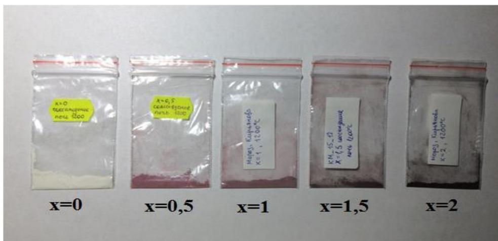
Рис.4. Цвета образцов после их обжига в печи при 1200°C
