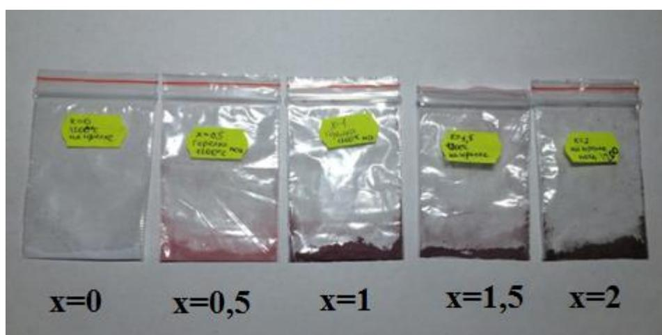
*Рис.6.Цвета образцов после обжига в печи при  $1200^\circ\text{C}$*
