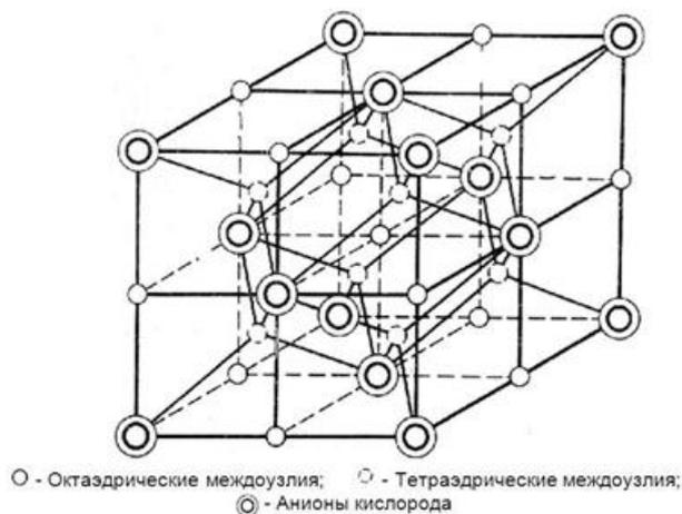
По характеру распределения катионов в занятых тетраэдрических и октаэдрических позициях выделяют следующие типы шпинелей:
