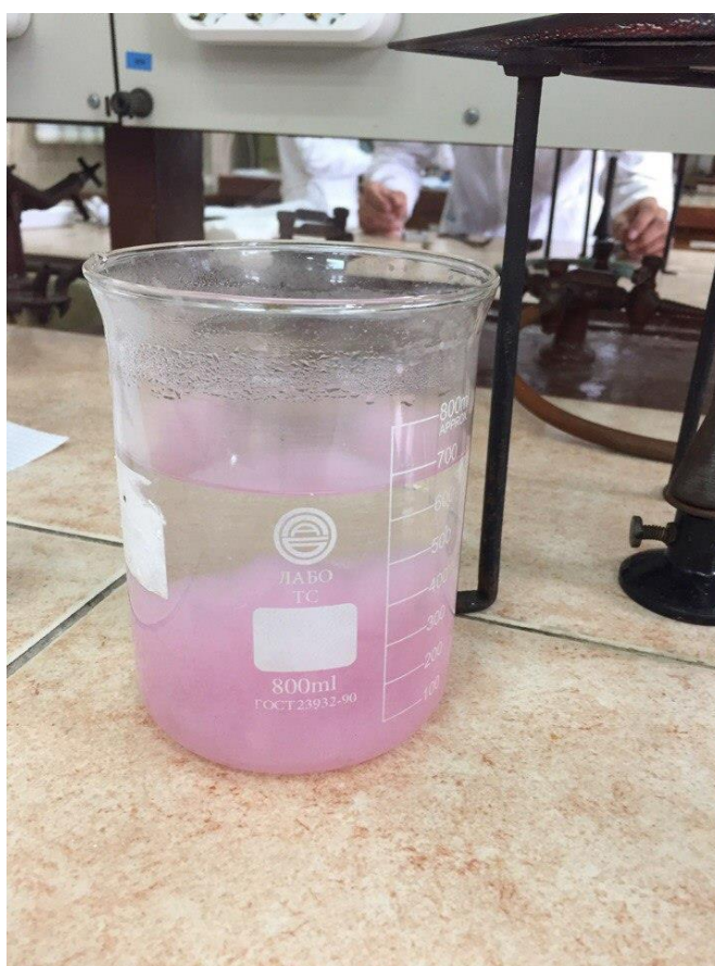
«Сопелька» Осажденные гидроксида кобальта, алюминия и цинка
