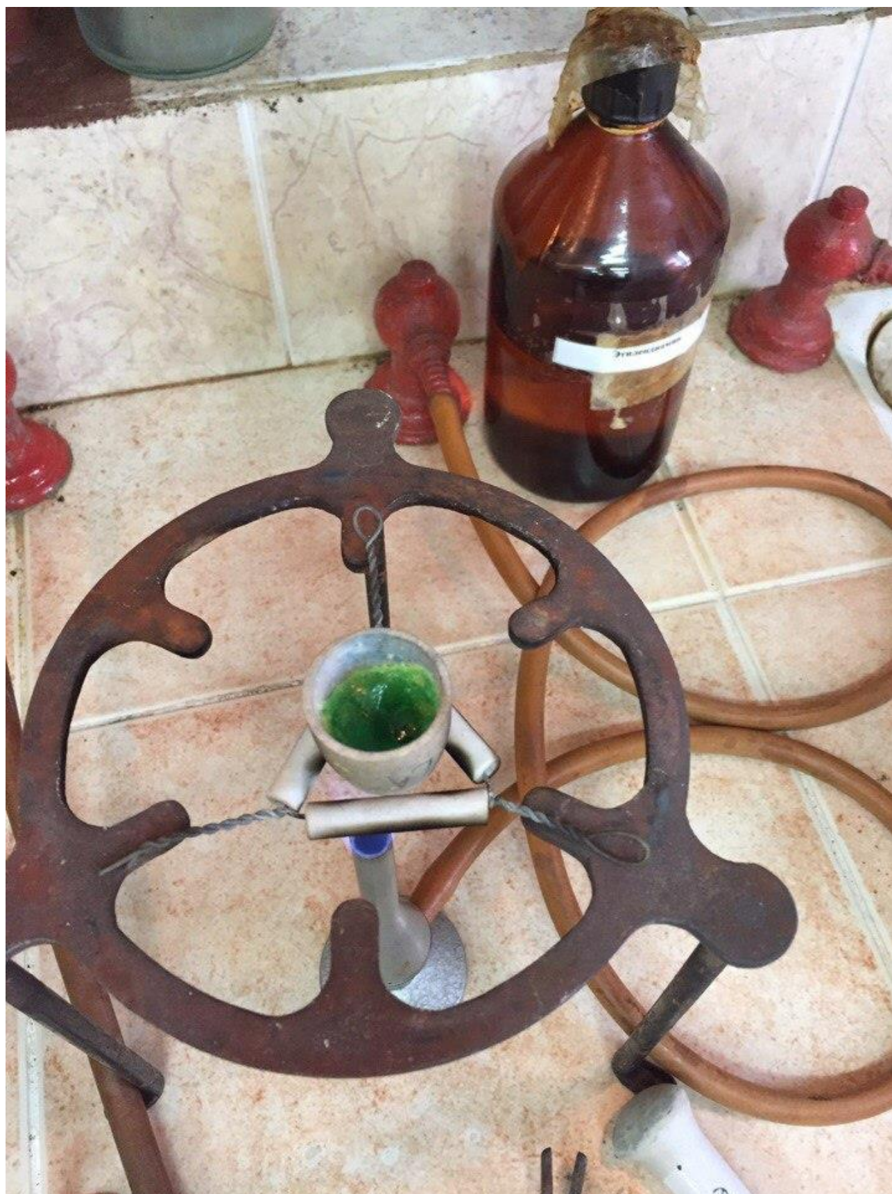
Прокаливание никелевого шенита, алюмоаммонийных квасцов и цинкового шенита
