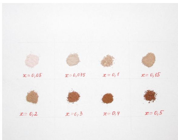
Рис.5. Цвета образцов состава Mn_xAl_{2-x}O_3 при 1200°C.
