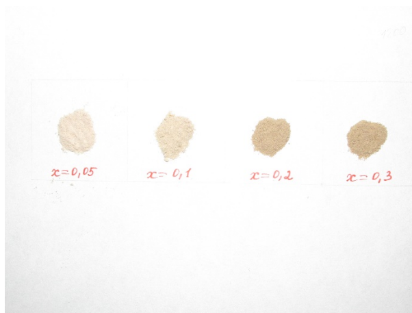
Рис.7. Цвета образцов состава MgMn_{2x}Al_{2-2x}O_4 при 900°C.
