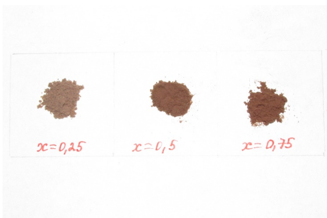
Рис.8. Цвета образцов состава Mg_{1-x}Mn_xAl_2O_4 при 900^\circ\text{C} .
