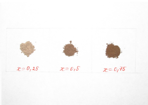
Рис.9. Цвета образцов состава Mg_{1-x}Mn_xAl_2O_4 при 900^\circ\text{C} .
