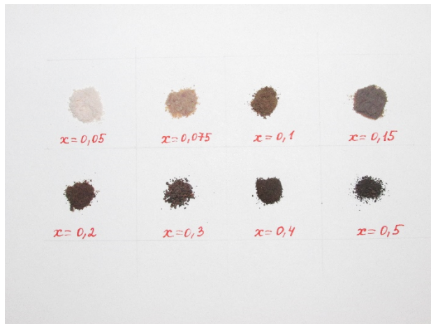
Рис.4. Цвета образцов состава Mn_xAl_{2-x}O_3 при 900°C.
