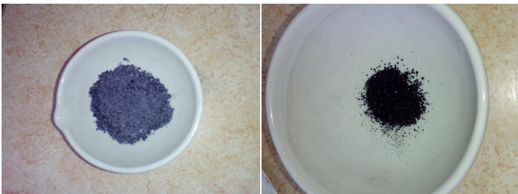
*Образцы до и после прокаливания на газовой горелке*
