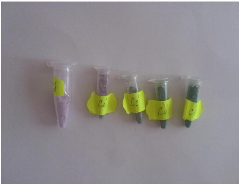
Готовые образцы для  $x$  от 0,1 до 0,9, отжиг при  $1200^{\circ}\text{C}$
