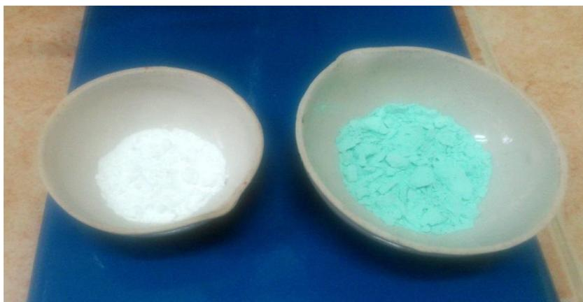
Затем взвешенные в нужной пропорции оксалаты магния и никеля перетираются в фарфоровой ступке. Полученная смесь помещается в
