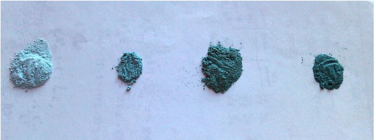
*Шпинель  $\text{Mg}_{1-x}\text{Ni}_x\text{Al}_2\text{O}_4$ : обжиг при 1200 – слева направо
