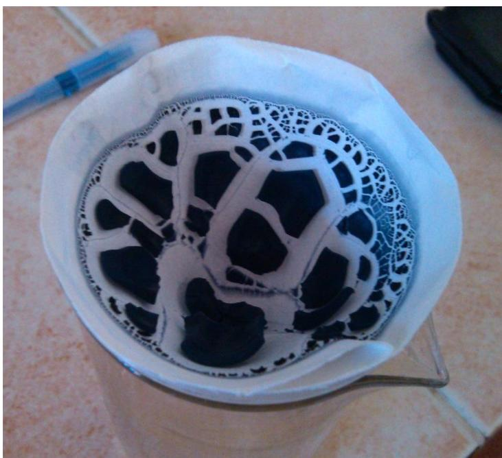
помощи магнитной мешалки. В результате реакции образуются гидроксиды алюминия и хрома. Выпавший осадок фильтруется на бумажном фильтре и затем сушится. После этого он помещается в алундовый тигель и прокаливается сначала на газовой горелке, а затем – в
