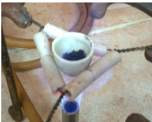
Рис. 6. Прокаливание в тигле на газовой горелке
