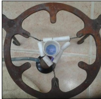
Далее образцы прокаливались в высокотемпературной печи при 900°C и при 1200°C в течение двух часов.
