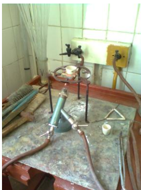
Рисунок 4. Прокаливание смеси на воздуходувной горелке
