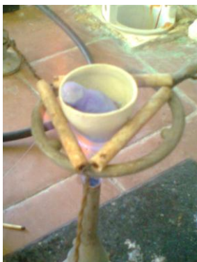
Рисунок 3. Прокаливание смеси на газовой горелке
