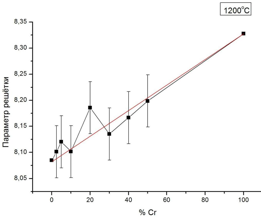
Как видно из графиков, образец с 20 %- ным содержанием хрома в обоих случаях сильно отклоняется от предполагаемого значения. Прямая, обозначающая линейное возрастание параметра, не попадает в его ошибку (за ошибку принималась ошибка метода, равная 5 %). Рассмотрим рентгенограмму этого образца более подробно.
