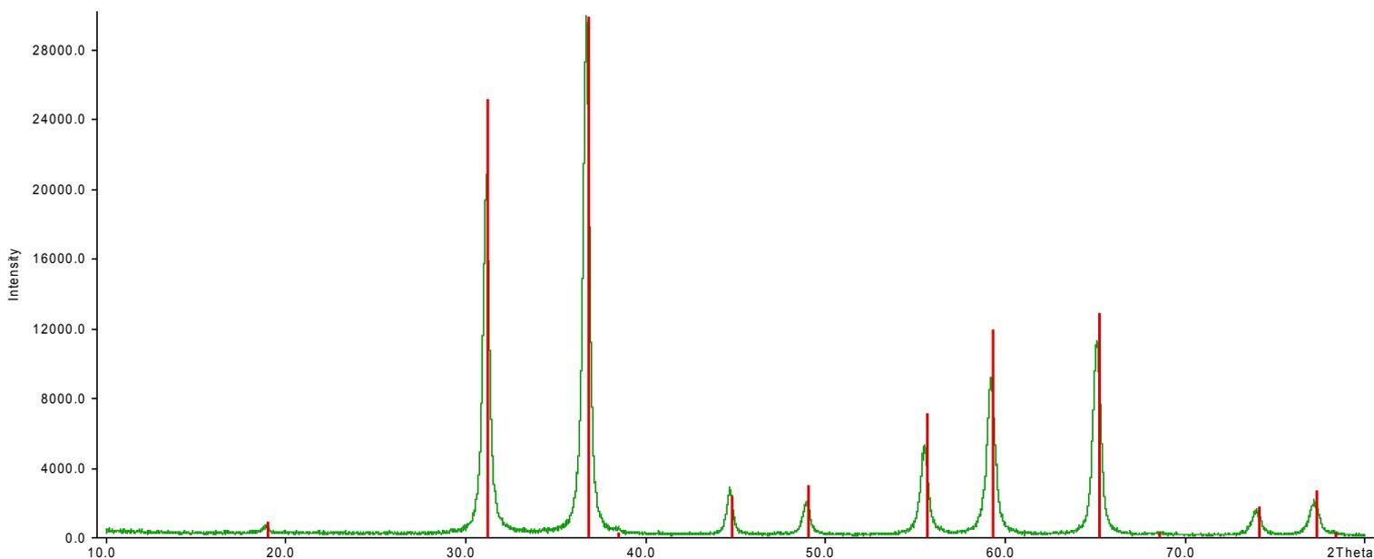
Красные линии соответствуют пикам цинк-алюминиевой шпинели. Наблюдается отклонение пиков полученных образцов, связанное с изменением параметра кристаллической решётки при допировании её хромом. Выполняется закон Брега: увеличение параметра решётки приводит к сдвигу пиков в сторону снижения мер углов.
