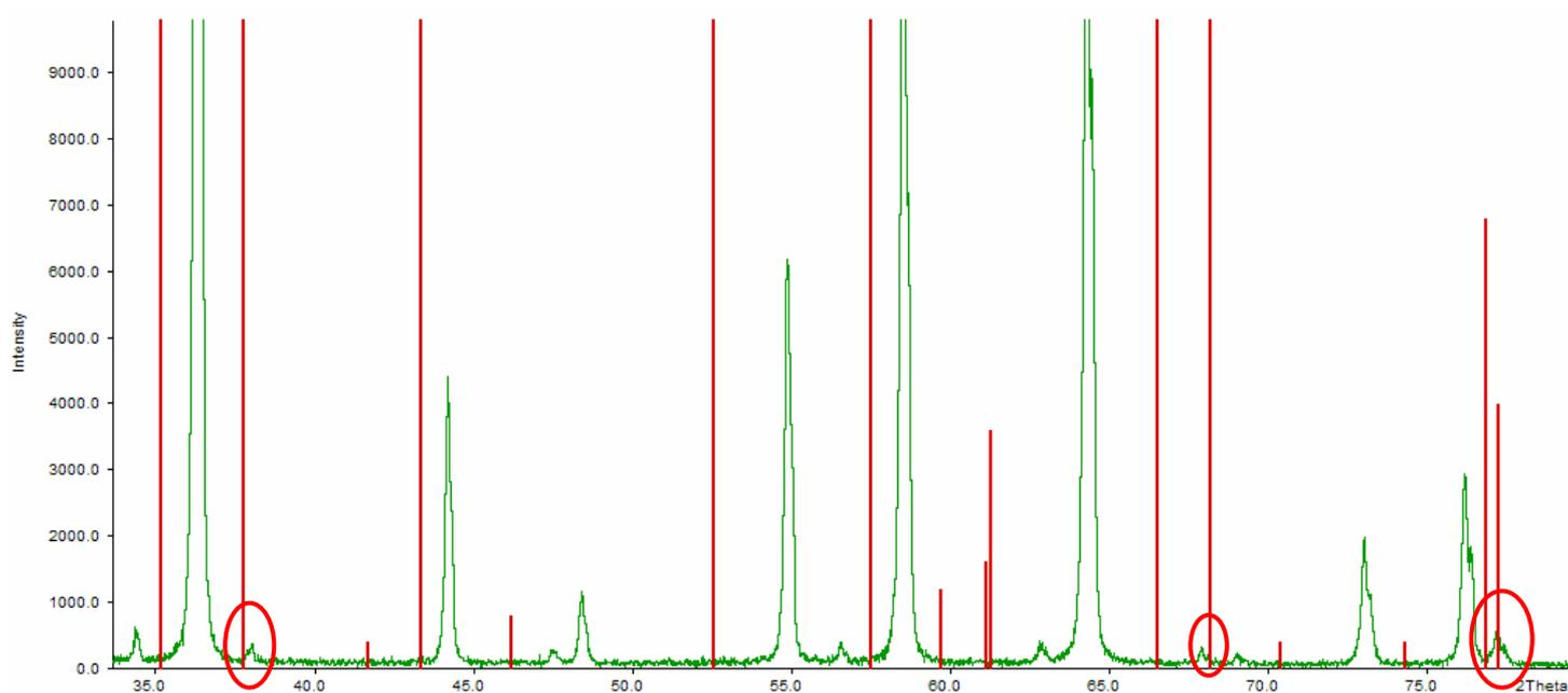
На дифрактограмме образца были обнаружены пики, не соответствующие пикам шпинели. Было установлено, что некоторые из них (отмечены овалами) совпадают с наиболее интенсивными пиками (красные линии) оксида хрома. Наличие примеси оксида хрома подтверждается цветовым анализом (образец имеет сизый оттенок). Однако некоторые пики не соответствуют ни оксиду хрома, ни оксиду алюминия. Остаётся только предположить, что образец был загрязнён посторонними примесями из тигля.
