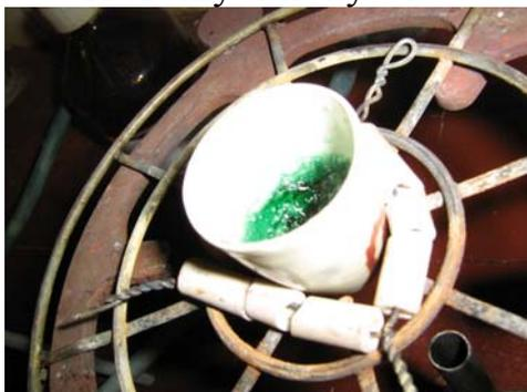
Но со временем расплав светлеет и приобретает окраску цвета молодой листвы. Чтобы прокаливание не было неравномерным, тигли периодически снимались нами с горелки, остывали. После чего порошки повторно тщательно перетирались и снова претерпевали прокаливание. Когда на обычной горелке перестают выделяться газы, порошок пересыпается в алундовый тигель, в
