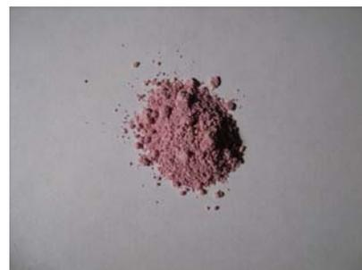
При высоких концентрациях хрома (в нашем случае 80%) наблюдается хорошая закристаллизованность шпинели:
