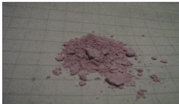
Рис. 15: фотография образца \text{Zn}(\text{Al}_{0.7}\text{Cr}_{0.3})_2\text{O}_4 , полученного спеканием.
