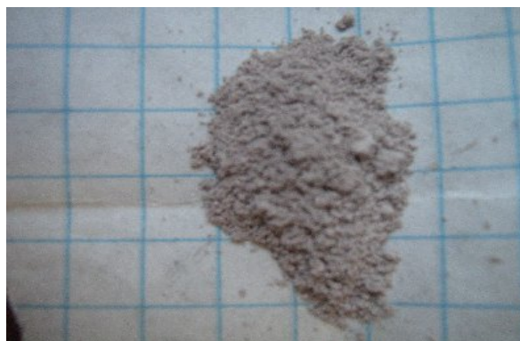
Рис. 11: 50% Cr, полученные методом спекания
