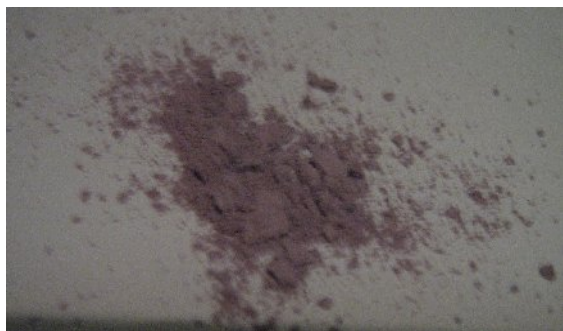
Рис. 16: фотография образца \text{Zn}(\text{Al}_{0.7}\text{Cr}_{0.3})_2\text{O}_4 , полученного соосаждением.
