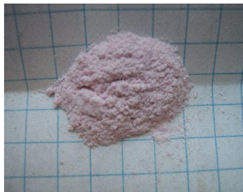
Рис. 12: Zn(Al_{0,9}Cr_{0,1})_2O_4 методом спекания.
