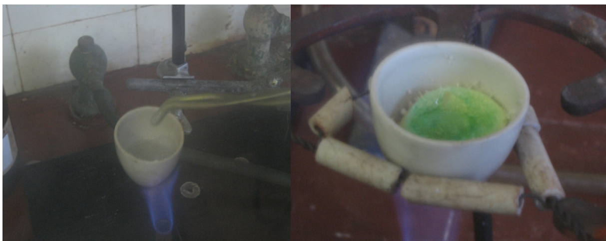
Рис. 3. Нагревание смеси прекурсоров на газовой горелке.
