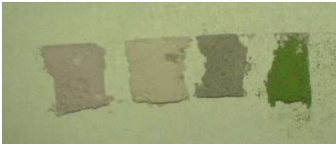
Рис. 4. Шпинель Mg(Al_{1-x}Cr_x)_2O_4 – слева направо x = 0,1; 0,2; 0,3; 0,7 .
