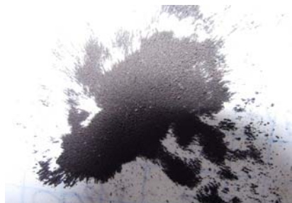
Образец, отожженный при 900С в течение 2 часов, в поле постоянного магнита
