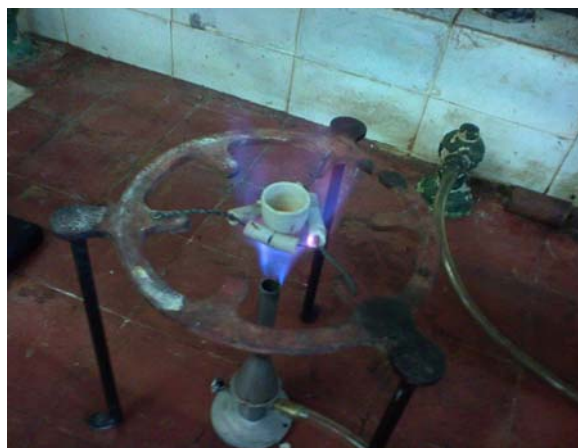
Прокаливание сульфатов на газовой горелке
