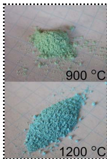
Рисунок 4.5 Результаты отжига 50% Al_2O_3 и 50% NiO при 900°С и 1200 °С
