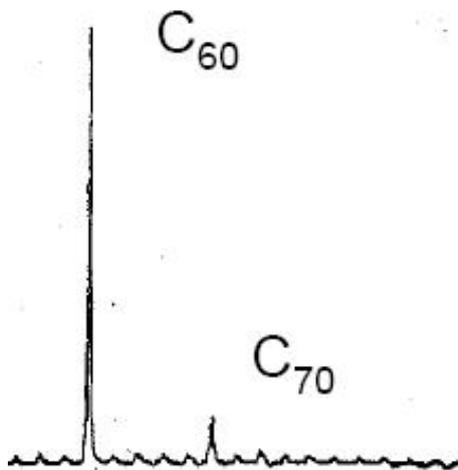
*Рис.2. Масс-спектр, доказывающий образование молекул C<sub>60</sub> и C<sub>70</sub>*
